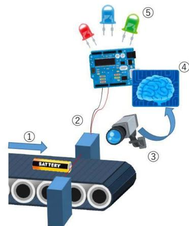
AIカメラを用いた選別装置
