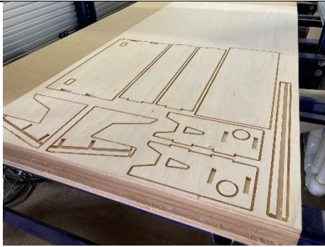
木プロテック/CNC ルーターでの試作開発 (モニターラック)
