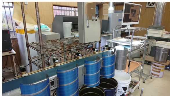
【廃乾電池自動選別システム】
